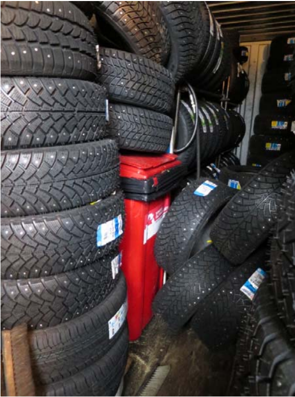
Kuva 5. Vaaralliset jätteet säilytettiin samassa kontissa renkaiden kanssa. Pääsy jäteastiolle oli mahdotonta. Kontissa varastoitii pohjaventtiilissä IBC-kontissa ilman suoja-allasta myös jarru- ja kytkinnestejätettä.
