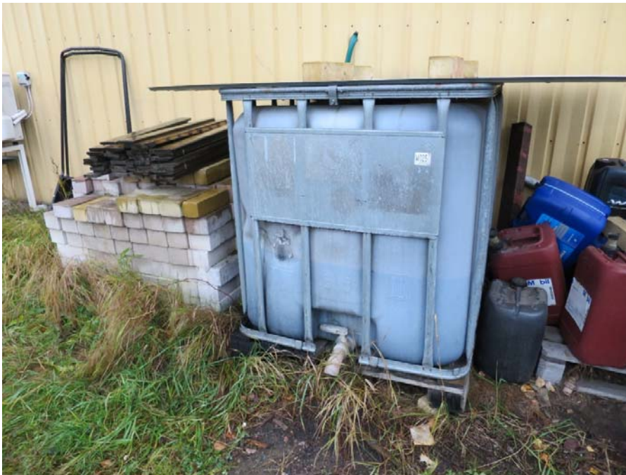
Kuva 4. Jäteöljyä varastossa ulkona maapohjalla suoja-altaattomassa IBC-kontissa, jonka alaosassa olevan venttiin kautta jäteöljy voi purkautua suoraan maahan.
