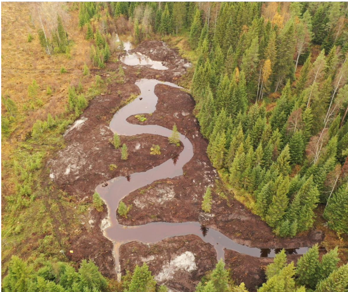
Kosteikon mutkittleva muoto lisää hidastaa veden virtausta kosteikolla ja lisää sen viipymää, mikä tehostaa ravinteiden sitoutumista ja kiintoaineen vajoamista. Kapea ja pitkänomainen muoto vähentää myös kaivumassojen siirtoja, kun ne voidaan tehdä yhdellä siirrolla molemmin puolin vesialuetta reunoille. Ylivieskan Äkkilän kosteikko 2020 Juha Siekkinen..
